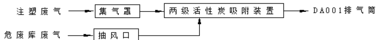
图 4-1 项目注塑废气、危废贮存废气收集及处置图
